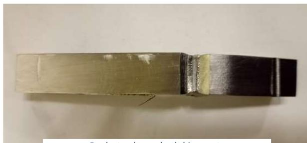
*Probeta después del impacto*
