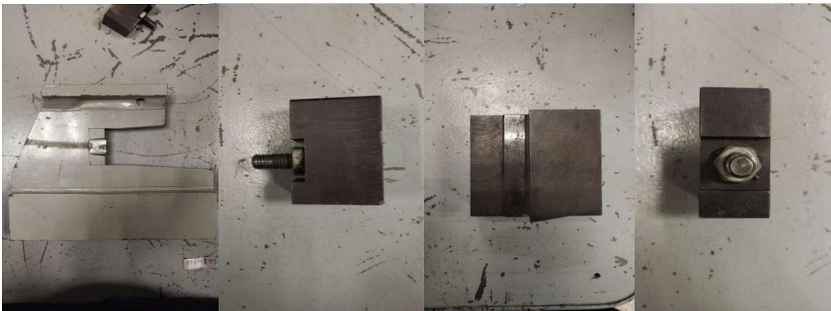
Martillo con percutor para ensayos Charpy (primera imagen). Sujetadores y apoyos para probetas Charpy ordenados como se deben colocar en la máquina (Segunda, tercera y cuarta imagen)
