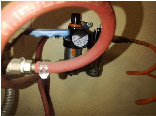
*Manómetro y mangueras de la compresora*
